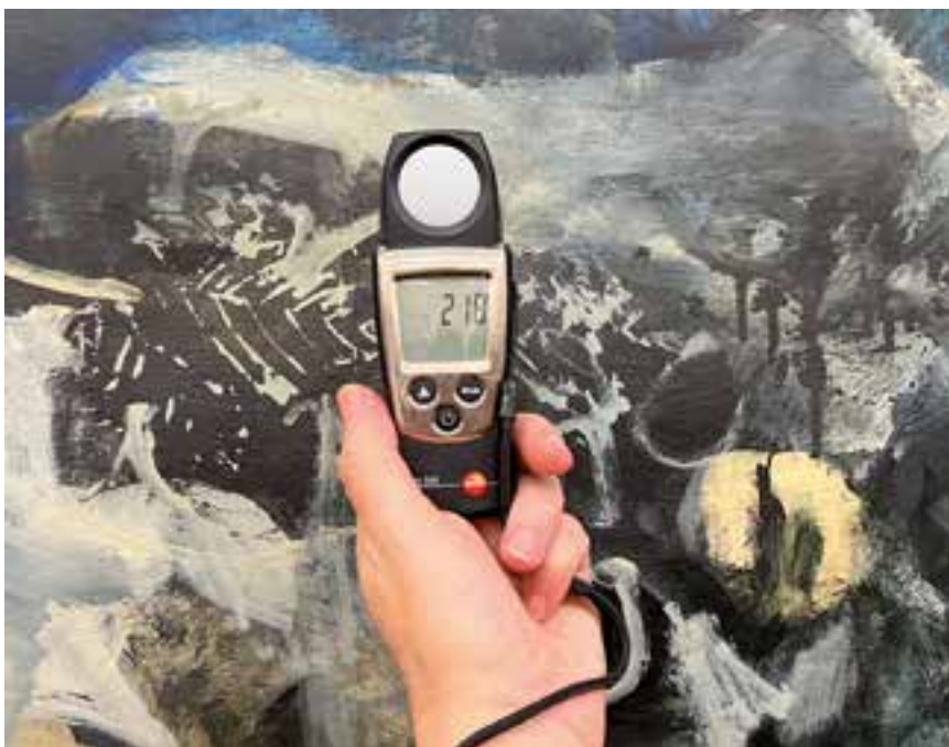
Comprovació amb luxímetre d'una sobreexposició a la llum.
