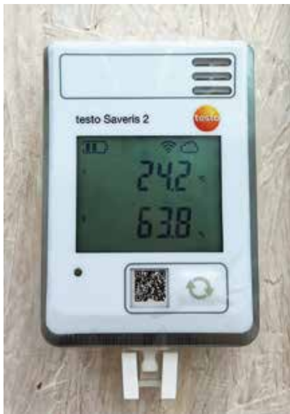
Datalogger per enregistrar la humitat relativa i la temperatura.
